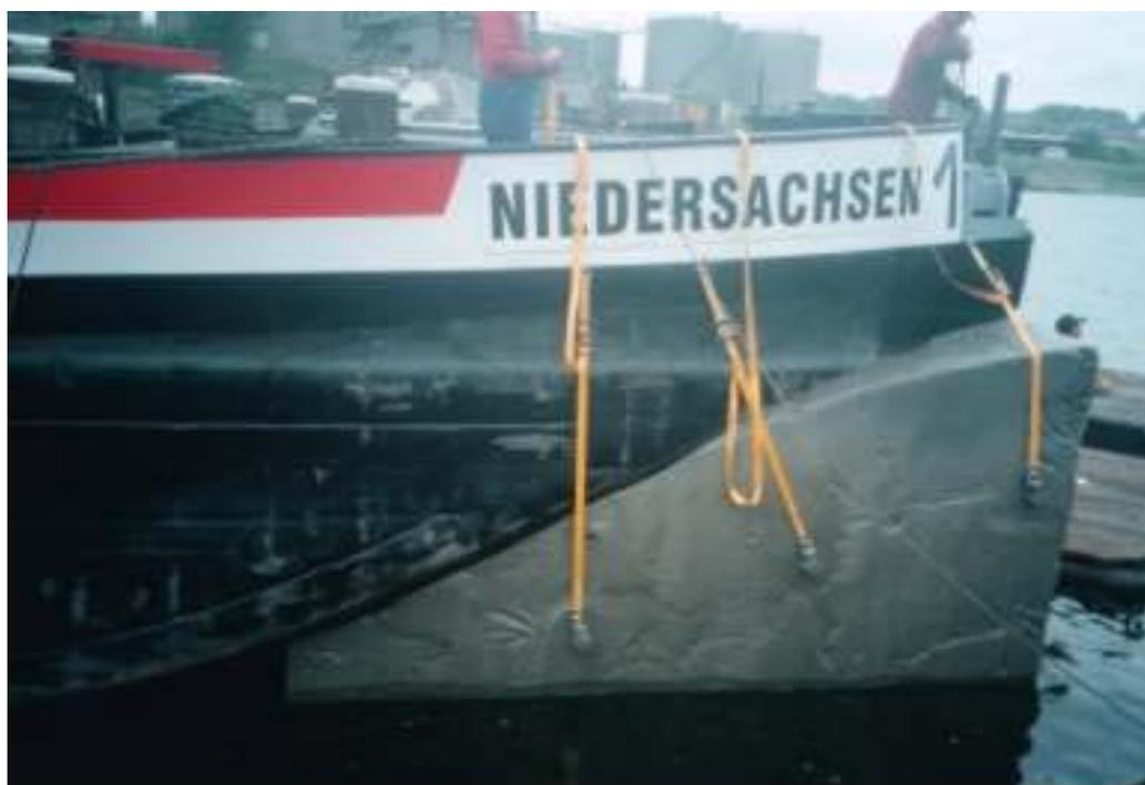
Abb. 14 Großversuch mit Hartschaumkeil im Vorschiffsbereich [Foto VBD]
